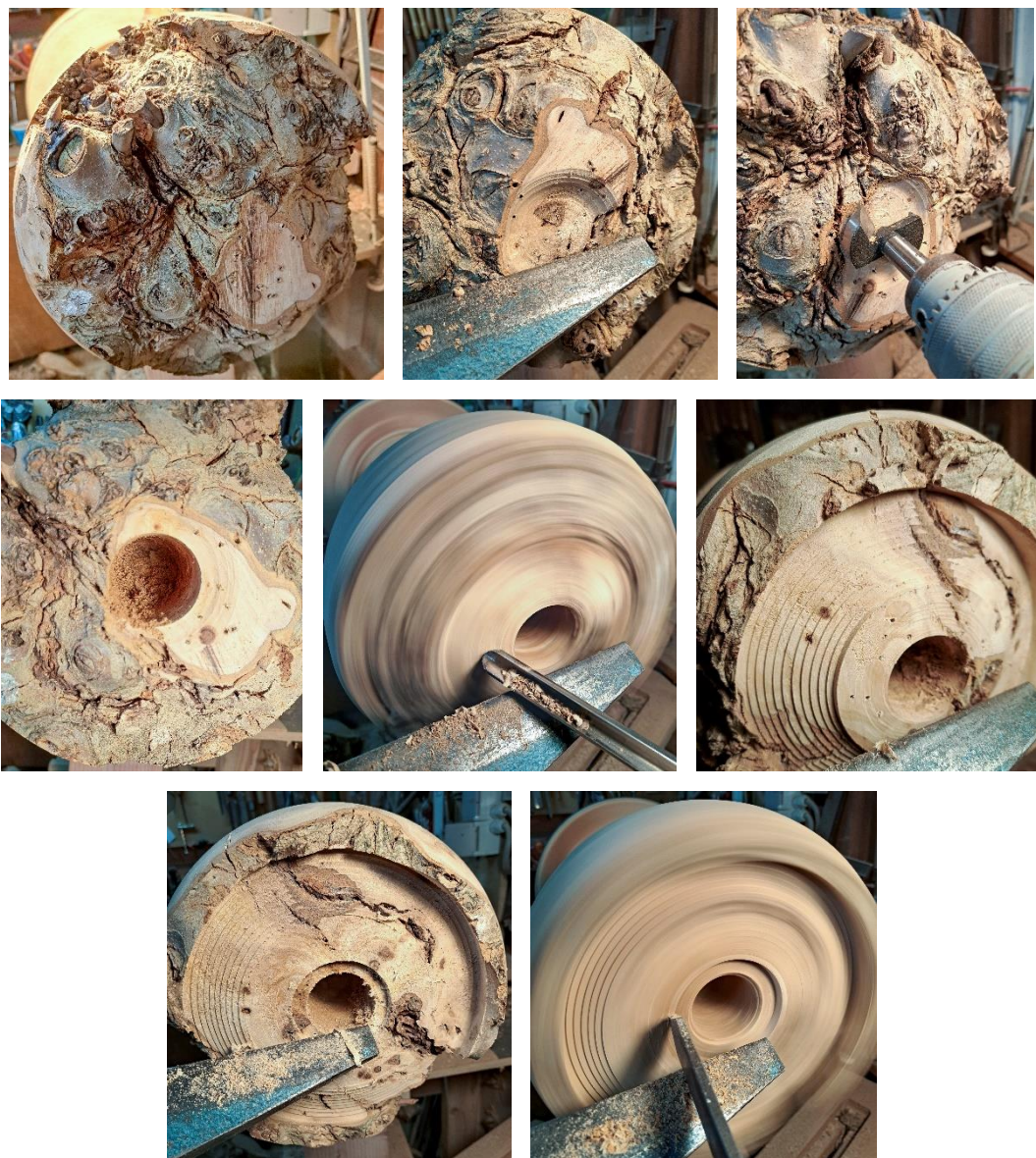
Figuur 298, 299, 300 en 301: Bovenkant pot: plat vlak snijden – holte snijden – gat boren (Bron: JME) Figuur 302, 303, 304 en 305: Het snijden van de koepel en de opstaande rand (Bron: JME)
