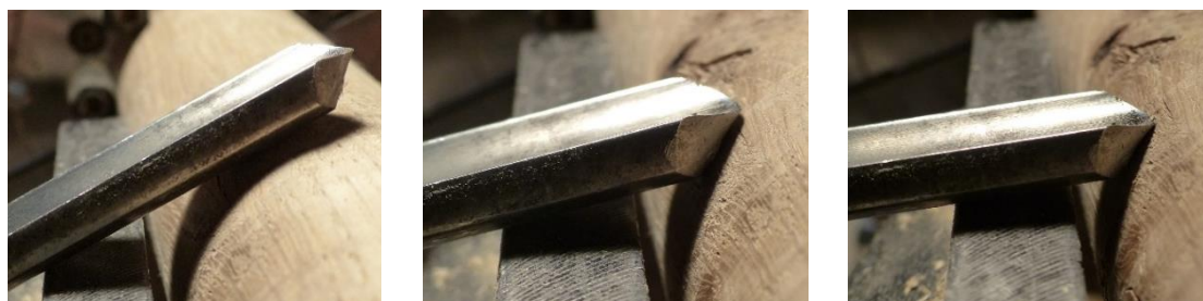
figuur 115: het A-B-C van het snijdend houtdraaien (bron: JM Eckeloo)
